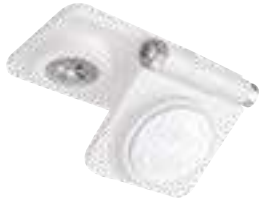
BASE MÓVIL CON IMÁN BLANCO: P3737-000 CLAVES NEGRO: P3737-300 LA BASE MÓVIL CON IMÁN PERMITE COLOCAR LAS LUMINARIAS BL FLAT EN SUPERFICIES LISAS O RUGOSAS, PERMITIENDO ORIENTAR LA LUMINARIA A 45°.
